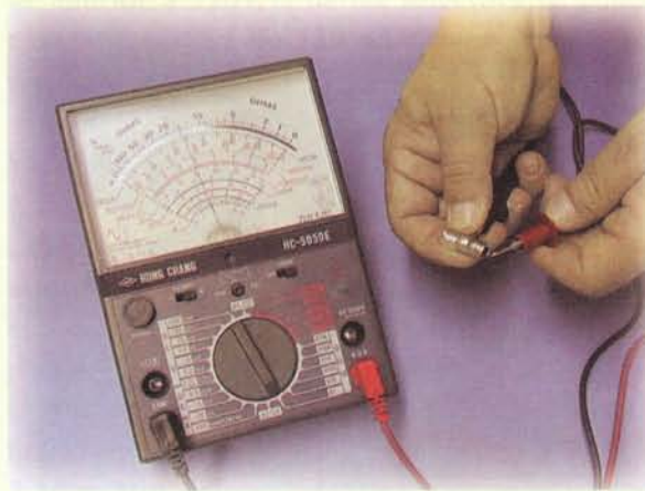
Figura 3.6. Medida de continuidad de una bombilla
